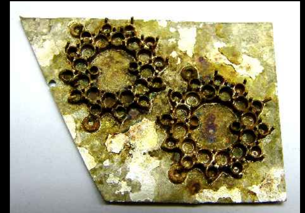
3. mal säurebehandelt, geschliff und eine Hälfte „gekratzt“
